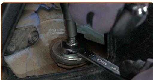
Výměna: tlumiče pérování - OPEL Corsa B Van (S93). AUTODOC doporučuje:
