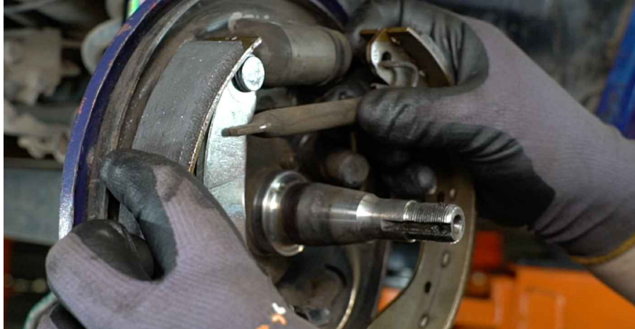
37 Nainstalujte spodní zpětnou pružinu.
