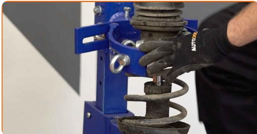
Výměna: pérovací jednotka - OPEL Corsa C Van (X01). Doporučují odborníci z AUTODOC:
