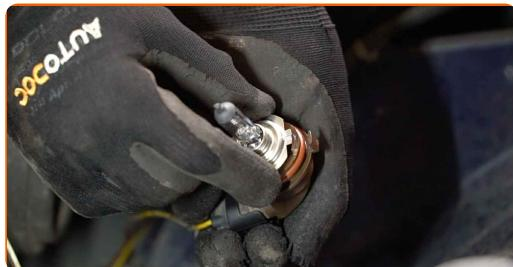
Výměna: žárovky hlavního světlometu - OPEL Meriva A (X03). AUTODOC doporučuje:
