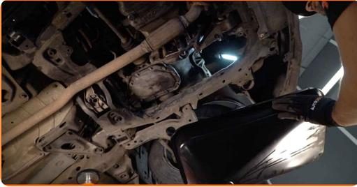
9 Odšroubujte upevňovací prvky vany převodové kapaliny. Použijte nástavec č.11. Použijte ráčnový klíč.
