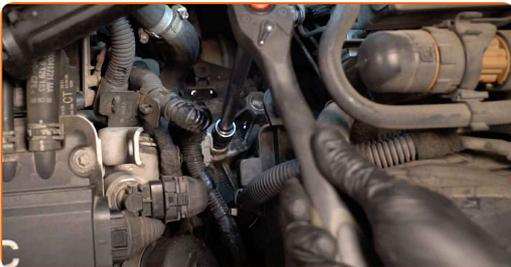
22 Vložte trychtýř. Nalijte novou převodovou kapalinu do převodové skříně přes otvor odvzdušňovacího ventilu. Potřebné množství oleje: 1.6 l.
