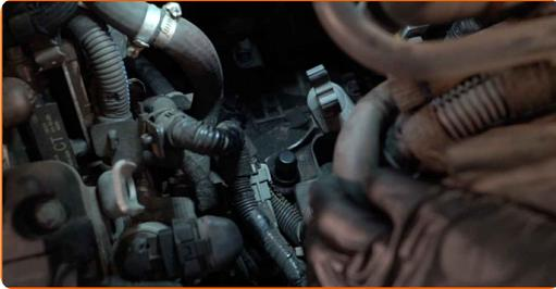
20 Vyčistěte odvzdušňovací ventil převodovky. Použijte víceúčelový čisticí sprej.
