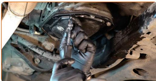
19 Odstraňte držáky a chladicí trubku dejte stranou.
