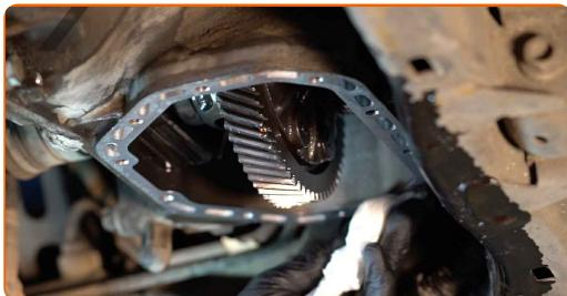
Výměna: olej do manuální převodovky - OPEL Signum CC (Z03). Tip od AUTODOC:
