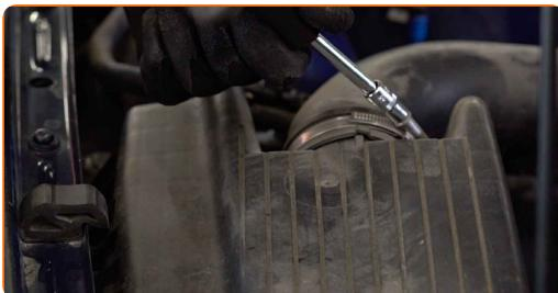
**5** Odpojte trubku na přívod vzduchu od krytu vzduchového filtru.
