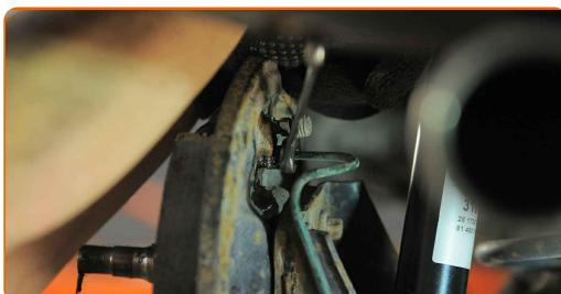
Výměna: brzdového válečku - OPEL Vectra A Sedan (J89). AUTODOC doporučuje:
