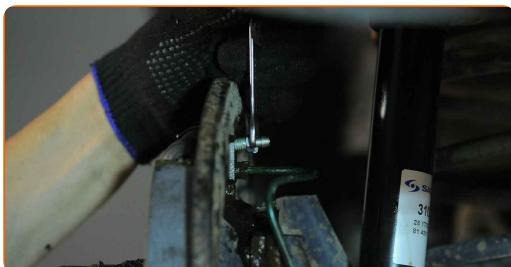
Výměna: brzdového válečku - OPEL Vectra A Sedan (J89). Tip:
