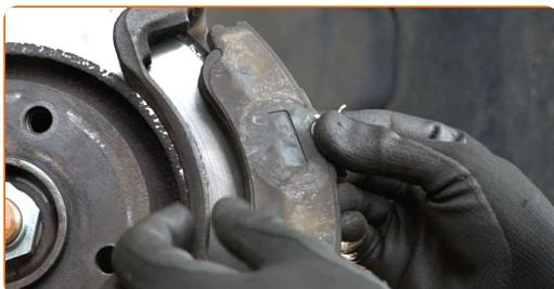
Výměna: brzdové destičky - PEUGEOT 2008 Combi (CU\_). Tip od AUTODOC:
