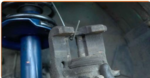
Výměna: brzdové destičky - PEUGEOT 2008 Combi (CU\_). Doporučují odborníci z AUTODOC:
