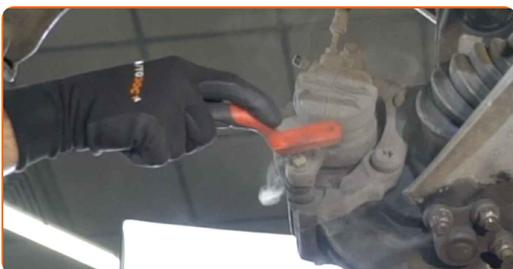
8 Odšroubujte upevnění brzdového třmenu. Použijte kombinační klíč č.13.
