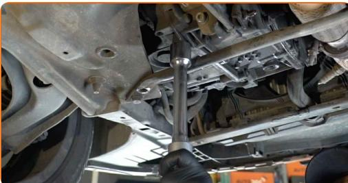
Výměna: silentbloku motoru - PEUGEOT 207 SW. Tip:
