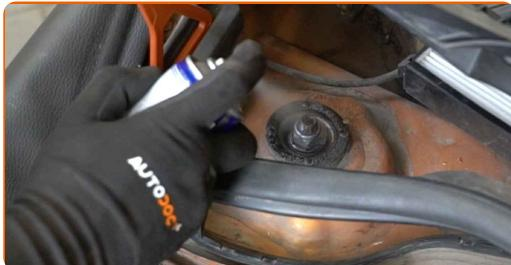
6 Uvolněte vrchní upevňovací prvek ložiska vzpěry tlumiče. Použijte kombinační klíč č.21. Použijte imbusový klíč č. H7. Použijte ráčnový klíč.
