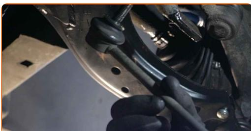
Výměna: tyčky stabilizátoru - PEUGEOT 306 Combi. Profesionálové doporučují:
