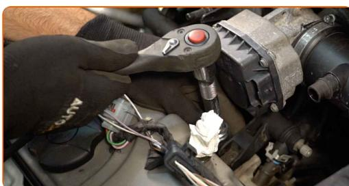
Výměna: zapalovacích svíček - PEUGEOT 306 Van / Hatchback. AUTODOC doporučuje:
