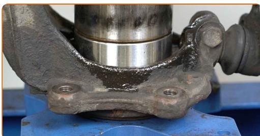
Výměna: ložiska kola - PEUGEOT 307 Combi (3E). AUTODOC doporučuje:
