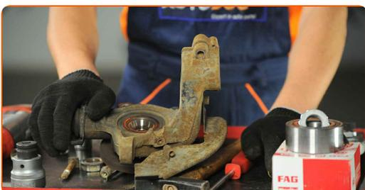
**37** Odstraňte náboj kola z kloubu řízení. Použijte sadu vložky a ořechu ložiska. Použijte kladivo.
