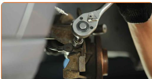
**31** Odstraňte ABS snímač z hlavy ložiska čepu kola.
