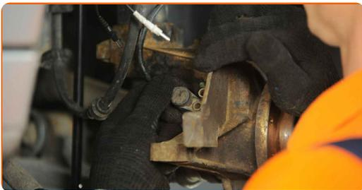
**32** Vyčistěte spodní upevnění spojující tlumič k hlavě ložiska čepu kola. Použijte drátěný kartáč. Použijte sprej WD-40.
