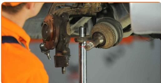
Výměna: ložiska kola - PEUGEOT 405 I Combi (15E). Tip od odborníků z AUTODOC:
