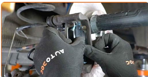
Výměna: brzdové destičky - PEUGEOT 405 II Combi (4E). Doporučují odborníci z AUTODOC:
