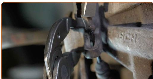
9 Vyčistěte upevňovací prvky brzdového třmenu. Použijte drátěný kartáč. Použijte víceúčelový čisticí sprej.
