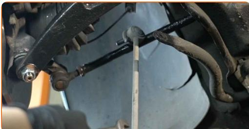
Výměna: tyčky stabilizátoru - PEUGEOT 5008 I (0U\_, 0E\_). Tip od odborníků z AUTODOC:
