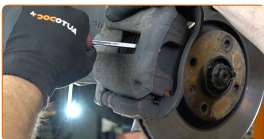
**13** Odstraňte brzdový třmen. Použijte páčidlo.
