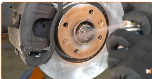
**26** Vyčistěte povrch brzdového kotouče. Použijte čistič brzd.
