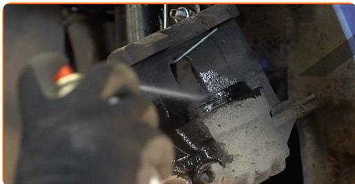
**19** Zatlačte píst brzdového třmenu. Použijte přípravek na zatlačení brzdových pístků.
