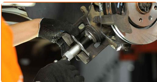
**20** Nainstalujte brzdový třmen a upevněte jej.
