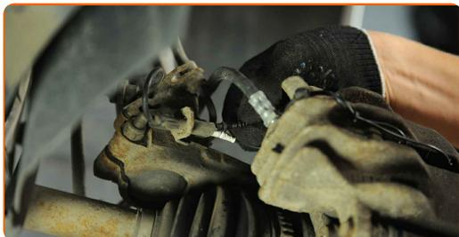
**25** Natřete povrch, kde je brzdový kotouč v kontaktu s ráfem kola. Použijte vysokoteplotní keramické mazivo.
