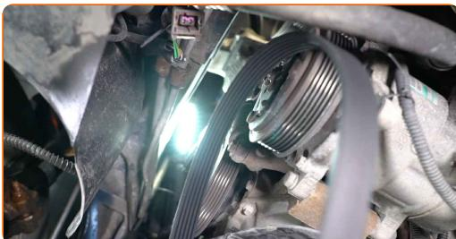
Výměna: drážkového řemene - PEUGEOT Boxer Mikrobus (230). Doporučují odborníci z AUTODOC:
