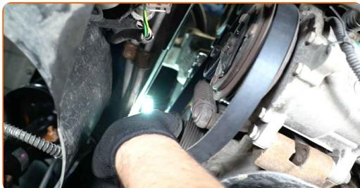
Výměna: drážkového řemene - PEUGEOT Boxer Mikrobus (230). Tip:
