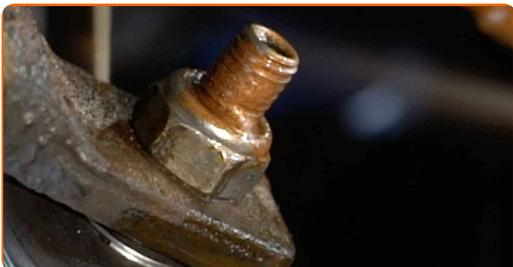
**16** Vyčistěte montážní otvor disku kola. Použijte drátěný kartáč.
