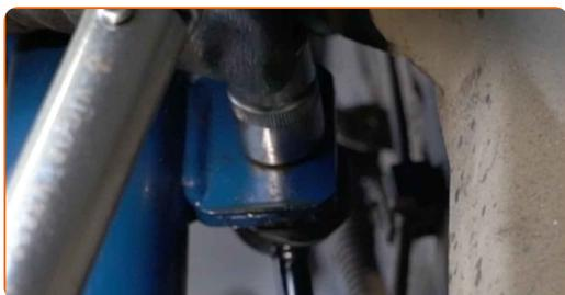
**15** Namažte všechna spojení vzpěry stabilizátoru. Použijte měděné mazivo.
