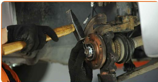
**61** Nainstalujte ABS snímač na hlavě ložiska čepu kola a zajistěte ho. Použijte nástavec č.10. Použijte ráčnový klíč.
