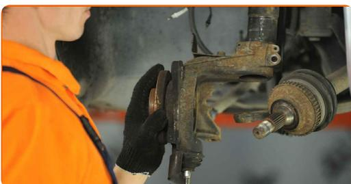
**30** Odšroubujte upevnění spojující ABS snímač k hlavě ložiska čepu kola. Použijte nástavec č.10. Použijte ráčnový klíč.
