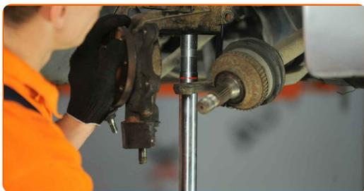
**50** Upevněte vzpěry tlumiče k táhlu řízení. Použijte kladivo.
