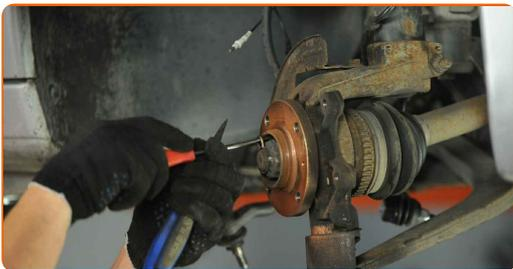
**26** Vyčistěte upevňovací prvek náboje kola. Použijte drátěný kartáč. Použijte sprej WD-40.
