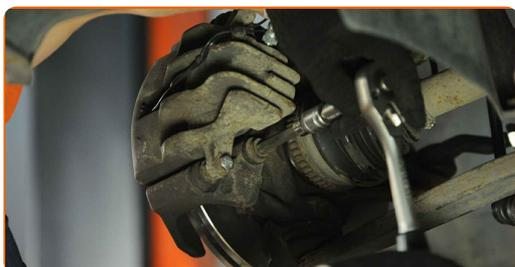
**76** Zapojte konektor snímače opotřebení brzdové destičky.
