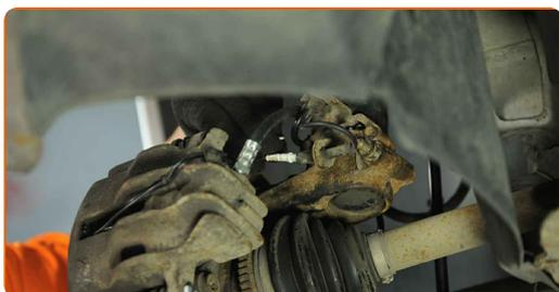
**77** Natřete upevnění spojující čep táhla řízení k hlavě ložiska čepu. Natřete upevňovací prvky hlavy ložiska čepu kola. Natřete upevňovací prvky držáku brzdového třmenu. Natřete upevňovací prvky spojující ovládací rameno k hlavě ložiska čepu nápravy. Použijte měděné mazivo.
