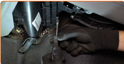
**5** Odstraňte kryt uložení kabinového filtru.
