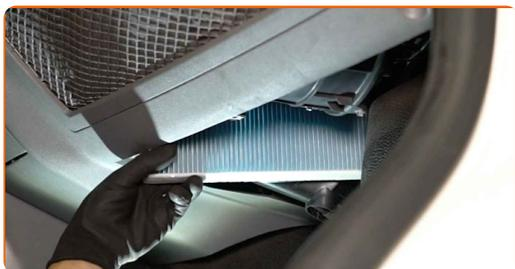
Výměna: kabinového filtru - PORSCHE Cayenne (9PA). AUTODOC doporučuje:
