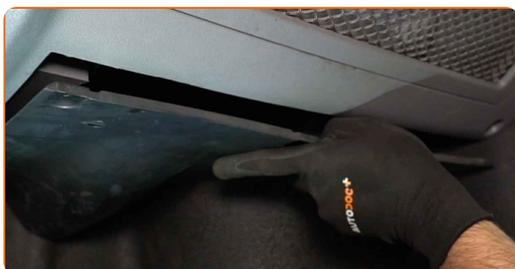
**4** Odšroubujte upevňovací prvky krytu pouzdra kabinového filtru. Použijte nástavec č.5,5. Použijte ráčnový klíč.
