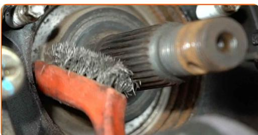
**31** Natřete drážky homokinetického kloubu hnací hřídele. Použijte měděné mazivo.
