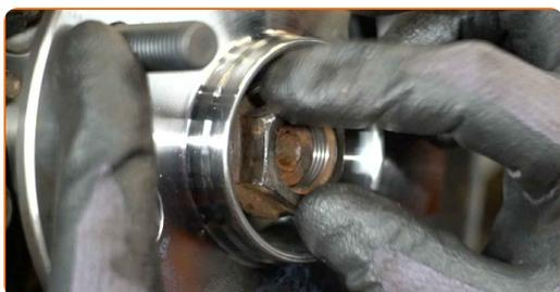
**35** Nainstalujte upevňovací matice.
