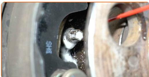
**25** Odšroubujte upevňovací prvky ložiska náboje kola. Použijte nástavec č.14. Použijte ráčnový klíč.
