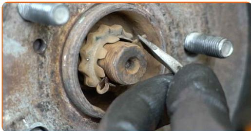
**7** Odstraňte zádržný kroužek ložiska náboje kola. Použijte páčidlo.
