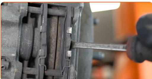
**17** Vyčistěte upeňovací prvky brzdového třmenu. Použijte drátěný kartáč. Použijte sprej WD-40.
