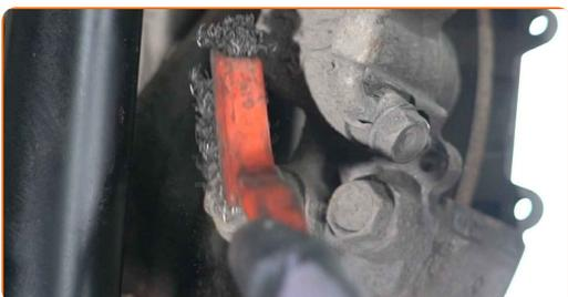
**18** Odšroubujte upeňovací prvky brzdového třmenu. Použijte nástavec č.14. Použijte ráčnový klíč.
