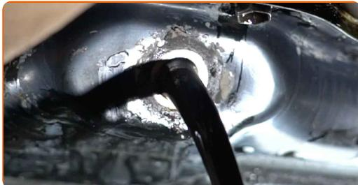
Výměna: motorového oleje a filtru - RENAULT Arkana I (LCM\_). Tip od AUTODOC:
