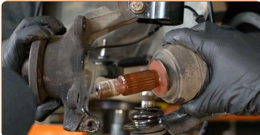
Výměna: ložiska kola - RENAULT Clio I Van. AUTODOC doporučuje:
