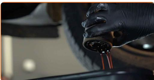
Výměna: motorového oleje a filtru - RENAULT CLIO IV karoserie. Doporučují odborníci z AUTODOC:
