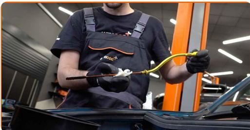
Výměna: motorového oleje a filtru - RENAULT CLIO IV karoserie Tip:
