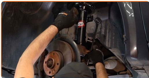
11 Utáhněte upevnění spojující vzpěru stabilizátoru a vzpěru tlumiče. Použijte nástavec č.14. Použijte kombinační klíč č.15. Použijte momentový klíč. Utáhněte ji točivým momentem 44 Nm.
