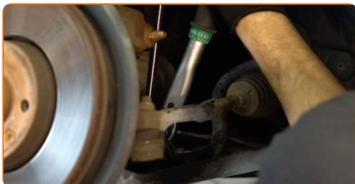
13 Namažte všechna spojení vzpěry stabilizátoru. Použijte měděné mazivo.
