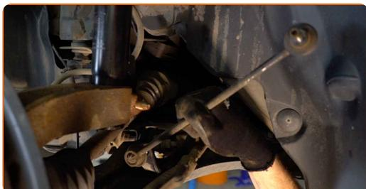
Výměna: tyčky stabilizátoru - RENAULT Kangoo II Be Bop (KW). Tip:
