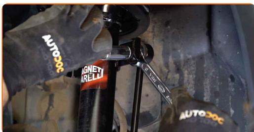
12 Utáhněte upevnění spojující vzpěru stabilizátoru a stabilizátor. Použijte nástavec č.14. Použijte kombinační klíč č.15. Použijte momentový klíč. Utáhněte ji točivým momentem 44 Nm.
