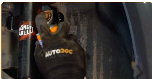
14 Vyčistěte montážní otvor disku kola. Použijte drátěný kartáč. Natřete kontaktní povrch. Použijte měděné mazivo.
