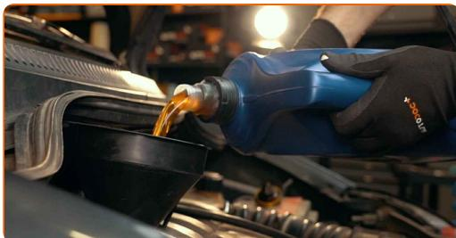
**Výměna: motorového oleje a filtru - RENAULT Laguna II Grandtour (KG). Tip od odborníků z AUTODOC:**
