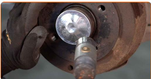
**20** Natřete povrch v místě kontaktu ráfku kola s bubnovou brzdou. Použijte měděné mazivo.
