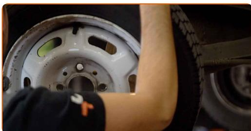
**6** Vyčistěte brzdový buben. Použijte drátěný kartáč. Použijte sprej WD-40.
