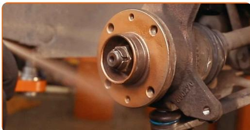
19 Nainstalujte brzdový kotouč.
