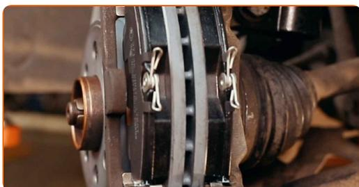
25 Natřete píst brzdového třmenu. Použijte nylonový čistící kartáč. Použijte čistič brzd.
