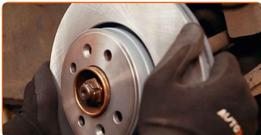
20 Upevněte upevnění brzdového kotouče. Použijte hvězdicový Torx T 40. Použijte momentový klíč. Utáhněte ji točivým momentem 14 Nm.
