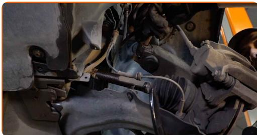
Výměna: uložení tlumiče - RENAULT Megane II Combi (KM). Doporučují odborníci z AUTODOC:
