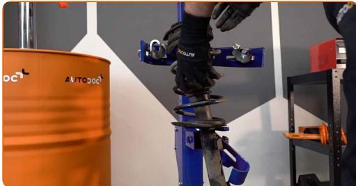
Výměna: uložení tlumiče - RENAULT Megane II Combi (KM). Tip od odborníků z AUTODOC:
