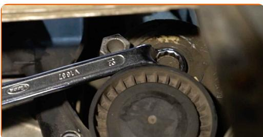
**49** Odstraňte napínací kladku ozubeného klinového řemene.
