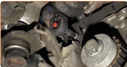
**48** Odšroubujte upevňovací prvek napínací kladky ozubeného klinového řemene. Použijte kombinační klíč č.13.
