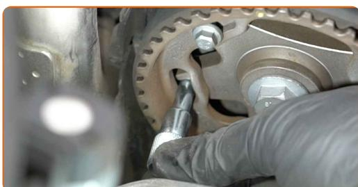
**41** Udělejte si značku na ozubeném kolečku vačkové hřídele.
