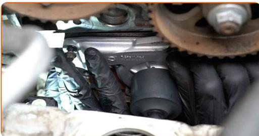
**63** Utáhněte upevňovací prvky vodní pumpy. Použijte nástavec č.8. Použijte momentový klíč. Utáhněte ji točivým momentem 12 Nm.
