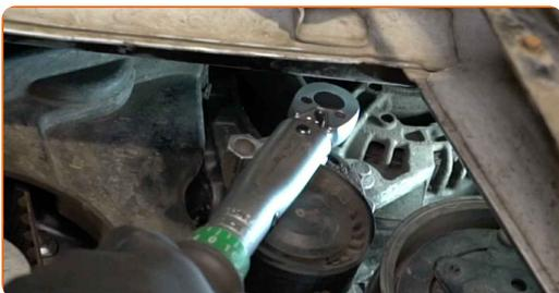
**87** Odšroubujte upevňovací prvek kladky klikové hřídele. Použijte nástavec č.18. Použijte ráčnový klíč.
