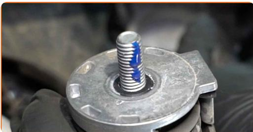
**85** Nainstalujte napínací kladku drážkovaného klinového řemene.
