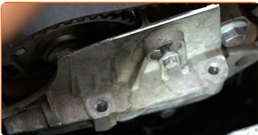
**77** Utáhněte upevňovací šrouby uložení motoru. Použijte nástavec č.10. Použijte momentový klíč. Utáhněte ji točivým momentem 40 Nm.
