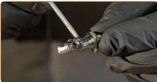
**61** Nainstalujte těsnění vodní pumpy.
