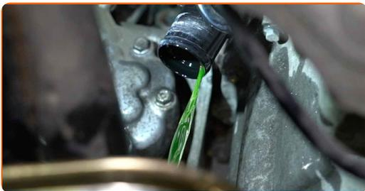
Výměna: vodní čerpadlo & sada rozvodového řemene - RENAULT Megane II Combi (KM). Profesionálové doporučují:
