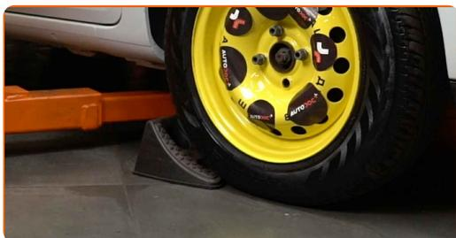
**7** Uvolněte upevňovací šrouby kola. Použijte rázový nástavec na kolo č. 17.
