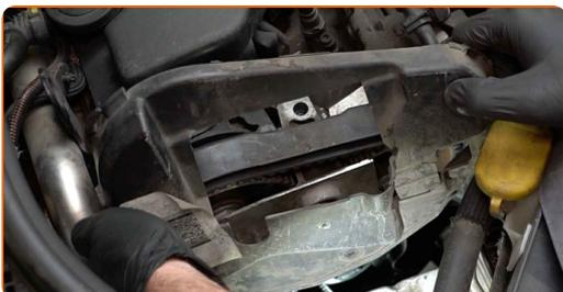
**79** Nainstalujte vrchní část uložení motoru.
