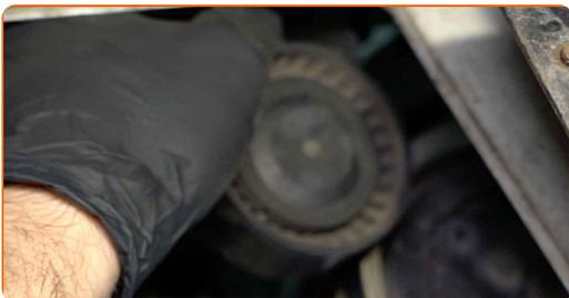
**86** Utáhněte upevňovací prvek napínací kladky drážkovaného klinového řemene. Použijte nástavec č.13. Použijte momentový klíč. Utáhněte ji točivým momentem 35 Nm.
