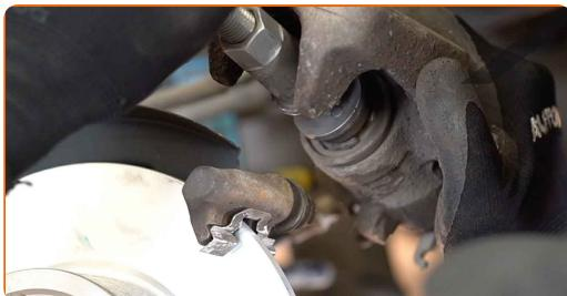
Výměna: brzdové destičky - RENAULT Scénic I (JA0/1\_, FA0\_). Tip od AUTODOC:
