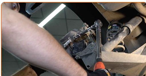
Výměna: brzdové destičky - RENAULT Scénic I (JA0/1\_, FA0\_). Doporučují odborníci z AUTODOC:
