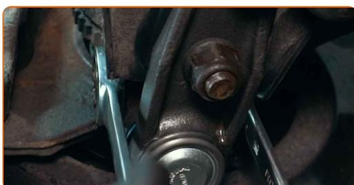
23 Upevněte svorku brzdového třmenu. Použijte nástavec č.18. Použijte momentový klíč. Utáhněte ji točivým momentem 100 Nm.
