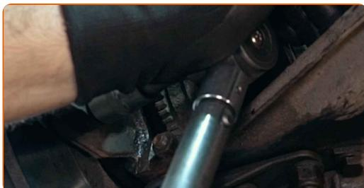
24 Utáhněte upevňovací prvky spojující kulový čep k ovládacímu ramenu. Použijte nástavec č.18. Použijte momentový klíč. Utáhněte ji točivým momentem 75 Nm.
