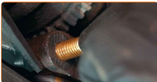
22 Zašroubujte upevňovací prvek spojující kulový čep k hlavě ložiska čepu nápravy. Použijte kombinační klíč č.16. Použijte nástavec č.16. Použijte ráčnový klíč.
