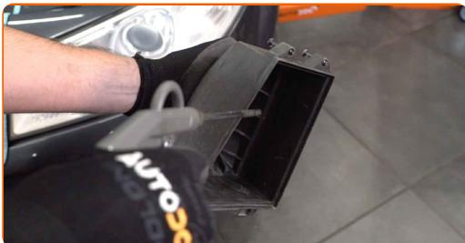
**Výměna: vzduchového filtru - RENAULT Trafic II Mikrobus (JL). Tip od AUTODOC:**
