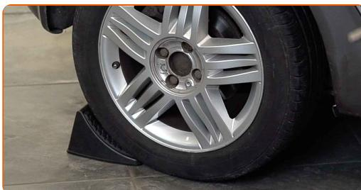
**3** Uvolněte upevňovací šrouby kola. Použijte rázový nástavec na kolo č. 19.
