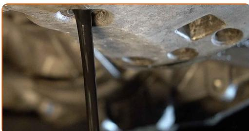
**Výměna: motorového oleje a filtru - RENAULT Twingo III Hatchback (BCM). Tip od odborníků z AUTODOC:**
