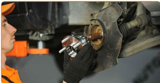
**24** Nainstalujte hnací hřídel do náboje kola.
