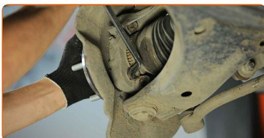
**27** Zapojte kulový čep k čepu řízení.
