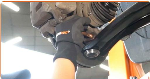
**29** Zašroubujte upevňovací prvek spojující kulový čep k hlavě ložiska čepu nápravy. Použijte kombinační klíč č.19. Použijte nástavec č.18. Použijte ráčnový klíč.
