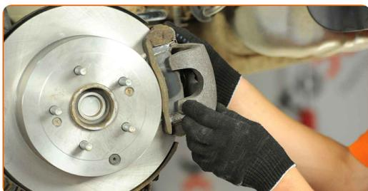
Výměna: brzdového kotouče - Hyundai Santa Fe CM. AUTODOC doporučuje:
