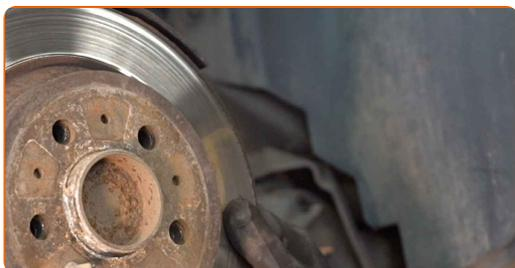
**18** Vyčistěte upevňovací prvky brzdového kotouče. Použijte drátěný kartáč. Použijte sprej WD-40.
