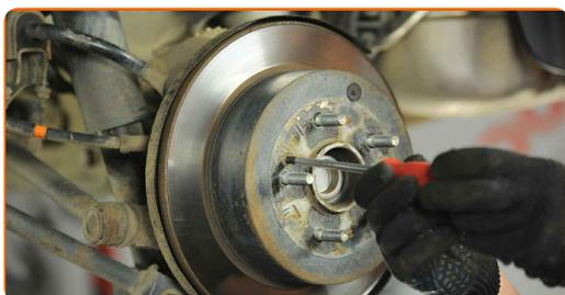
**20** Vyčistěte náboj. Použijte drátěný kartáč. Natřete kontaktní povrch. Použijte sprej WD-40.
