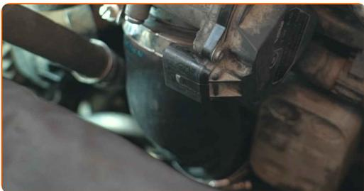
**60** Zašroubujte upevnění trubky měrky hladiny oleje. Použijte kombinační klíč č.10.
