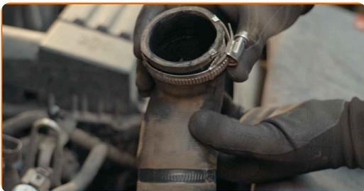
**10** Překryjte přívodní vzduchovou hadičku ručníkem z mikrovlákna, aby se do systému nedostal prach a špína.
