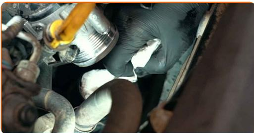
**58** Vyčistěte montážní pozici přívodní vzduchové hadice. Použijte víceúčelový čisticí sprej.
