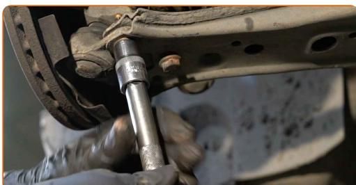
**55** Utáhněte upevnění kulového čepu. Použijte nástavec č.13. Použijte momentový klíč. Utáhněte ji točivým momentem 20 Nm.+90°
