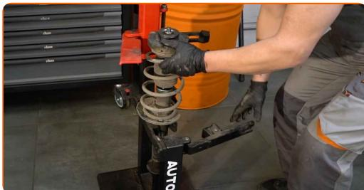
Výměna: uložení tlumiče - SEAT Córdoba I Vario (6K5). Tip od odborníků z AUTODOC:
