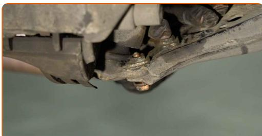
**54** Zašroubujte upevňovací prvky kulového čepu. Použijte nástavec č.13. Použijte ráčnový klíč.
