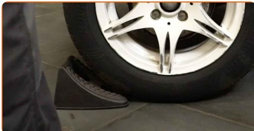
8 Uvolněte upevňovací šrouby kola. Použijte rázový nástavec na kolo č. 17.
