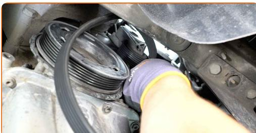
Výměna: drážkového řemene - SEAT Cordoba Sedan (6L2). AUTODOC doporučuje:
