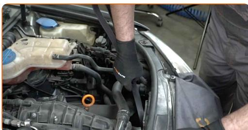
Výměna: drážkového řemene - SEAT Exeo Sedan (3R2). Tip:
