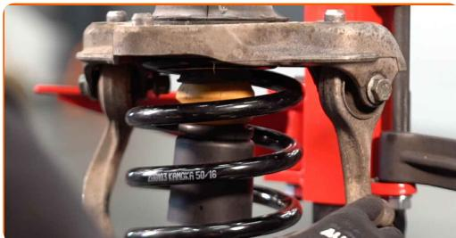
Výměna: pérovací jednotka - SEAT Exeo ST (3R5). Tip od odborníků z AUTODOC:
