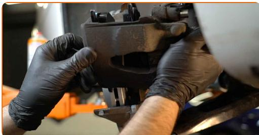
Výměna: brzdového třmenu - SEAT Ibiza IV Sportcoupe (6J, 6P). AUTODOC doporučuje:
