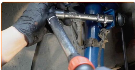
**13** Utáhněte upevnění spojující vzpěru stabilizátoru a stabilizátor. Použijte kombinační klíč č.17. Použijte nástavec č.17. Použijte momentový klíč. Utáhněte ji točivým momentem 40 Nm.
