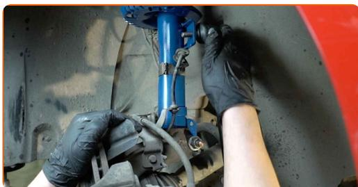
**12** Utáhněte upevnění spojující vzpěru stabilizátoru a vzpěru tlumiče. Použijte kombinační klíč č.17. Použijte nástavec č.17. Použijte momentový klíč. Utáhněte ji točivým momentem 40 Nm.
