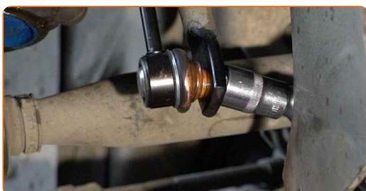
**14** Namažte všechna spojení vzpěry stabilizátoru. Použijte měděné mazivo.
