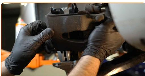
Výměna: brzdového třmenu - SEAT Ibiza IV ST (6J8, 6P8). AUTODOC doporučuje:
