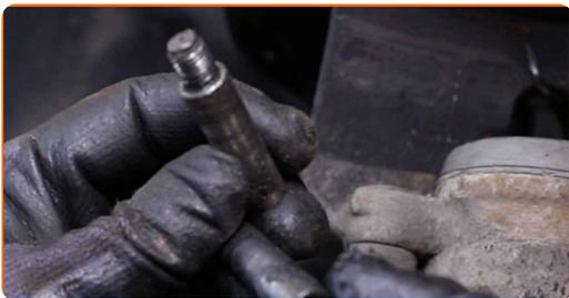
**15** Očistěte vodící závlačky brzdového třmenu. Použijte čistič brzd.
