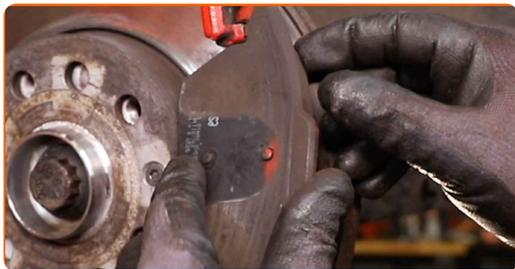
Výměna: brzdové destičky - SEAT Ibiza IV ST (6J8, 6P8). Tip:
